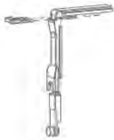
Köşe hareket aktarıcı Corner transmission for window
