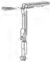
Köşe hareket aktarıcı Corner transmission for window
