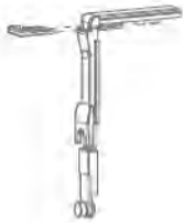
Köşe hareket aktarıcı Corner transmission for window
