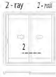
klasik sürme açılım sistem detayı classical sliding opening system detail
