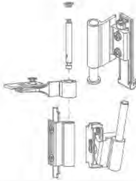
Çift açılım pencere üst menteşesi (130kg) Tilt and turn window top hinge (130kg)
