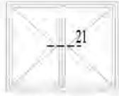
dışa açılır pencere outward opening window
