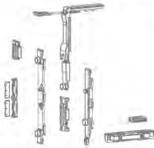
Çift açılım kilitleme mekanizması Tilt and turn base mechanism
