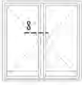
içe açılır kapı inward opening door
