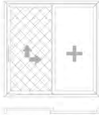
Kaldır-Sür mekanizması (max. 300kg) Lift & Sliding mechanism (max. 300kg)
