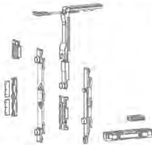
Çift açılım kilitmeme mekanizması Tilt and turn base mechanism
