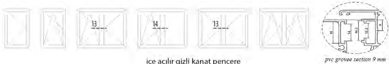
içe açılır gizli kanat pencere inward opening hidden sash window
